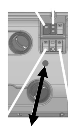
H11 Kontrollleuchte Überlast H11 Pilot lamp overload hopper
